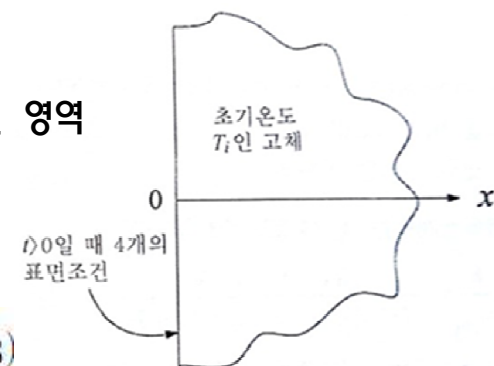
그림 4.13 반무한 고체 내에서의 과도열전도에 대한 경계조건
