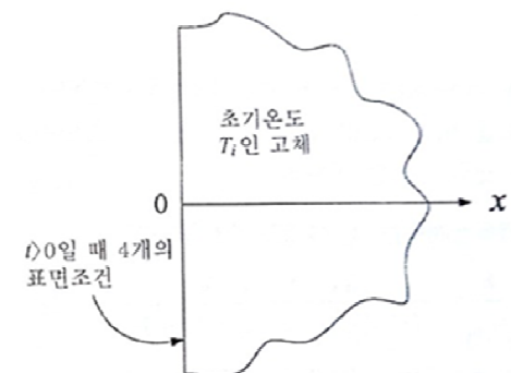
그림 4.13 반무한 고체 내에서의 과도열전도에 대한 경계조건
